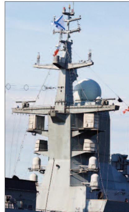
Интегрированная башенная мачтовая конструкция современного корвета.
